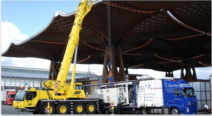
Mit einem Spezialauflieger-LKW, der eine Nutzlast von 26 t zulässt, wurde das Ausstellungsstück nach Deutschland gefahren. Dank verstärkter und verbreiterter Ladefläche des LKW's war eine Beladung mittels Kran möglich. Dadurch konnte die Maschine nach Eintreffen in Hannover im Messe-Freigelände entladen und anschliessend mit einem Schwerlastmafi in die Halle direkt an den Stand des Kunden geliefert werden.
